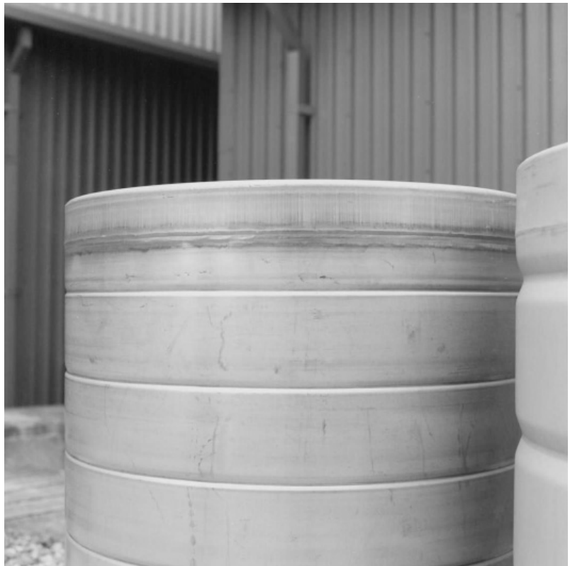
腐食したドラム缶
