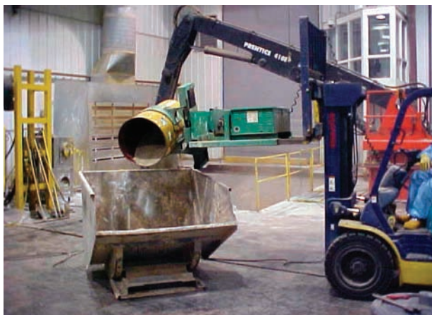
廃棄物のミキシングダンパーへの移送。
