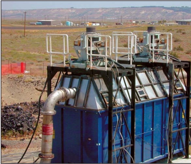
低放射能廃棄物のバルクガラス固化プロセスを試験するために、37立方ヤード（28.3立方メートル）の耐火物内張りロールオフ・ボックスが用意された。
