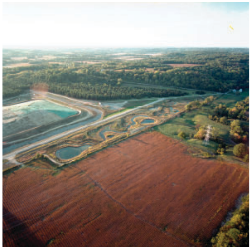
浄化作業時に破壊された湿地を埋め合わせるために、サイト北東隅付近に8つの低地からなる12エーカーの湿地を造成した。この湿地には、3,000本以上の高・低木と30種の草および野生の花が繁茂している。
